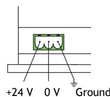
O comprimento máximo do cabo de alimentação eléctrica de 24 V CC é de 10 metros.
