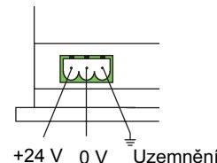
Maximální délka napájecího kabelu 24 V ss. je 10 metrů.
