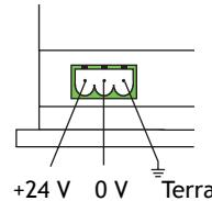
*La lunghezza massima del cavo di alimentazione 24 V DC è 10 metri.*
