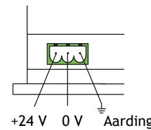
*De maximumlengte van de 24 V DC stroomtoevoerkabel is 10 meter.*
