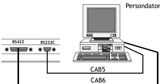
För programmering av terminalen måste programpaketet E-Designvara installerad på persondatorn. Kommunikationsparametrarna i terminalen och i E-Designer måste vara inställda på samma sätt.
