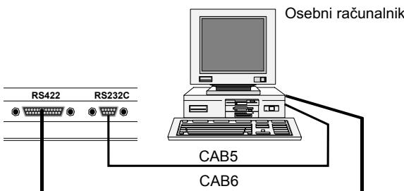
Za programiranje terminala priporočamo uporabo PC programa. Za instalacijo PC programa glej priročnik za PC program. V terminalu in PC programski opremi morajo biti parametri enako nastavljeni.
