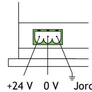
*Maximal längd på 24 V DC strömförskjningskabel är 10 meter.*
