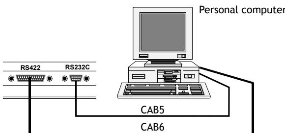
Για προγραμματισμό της συσκευής συνιστάται η χρήση του λογισμικού προγραμματισμού. Για την εγκατάσταση του λογισμικού προγραμματισμού, δείτε το εγχειρίδιο του προϊόντος. Οι παράμετροι επικοινωνίας στη συσκευή και στο λογισμικό προγραμματισμού θα πρέπει να τοποθετηθούν με τον ίδιο τρόπο.
