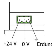
Die maximale Länge des Netzkabels (24 V GS) beträgt 10 m.
