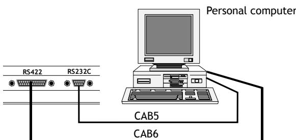
Die Programmierung des Terminals wird über die Software E-Designer vorgenommen. Die Kommunikationsparameter im Terminal und in der PC-Software müssen übereinstimmen.
