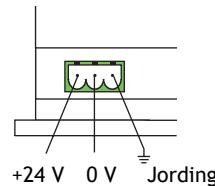
Maksimal lengde på 24 V DC strømtilførselsledning er 10 meter.
