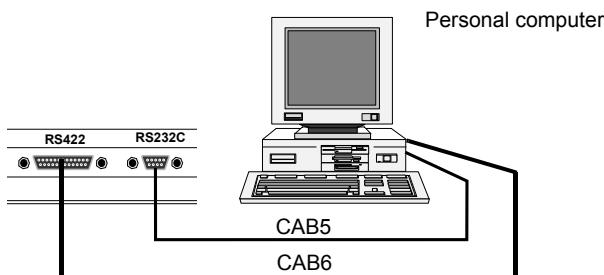
Pro programování terminálu se doporučuje software na PC. Instalace PC software je uvedena v manuálu tohoto produktu. Komunikační parametry v terminálu a v software PC musí být nastaveny stejně.
