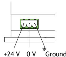
Μέγιστο μήκος καλωδίου τροφοδοσίας 24 VDC : 10 μέτρα.
