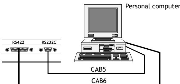
Om de terminal te programmeren wordt het aanbevolen om de PC software te gebruiken. Zie de handleiding van dit product om de PC software te installeren. De communicatie parameters in het bedieningspaneel en in de PC software dienen op dezelfde wijze ingesteld te worden.
