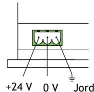
Længden af 24 V DC strømføringskablet må være max. 10 meter.
