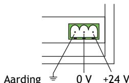
**Aansluiting op een printer**
