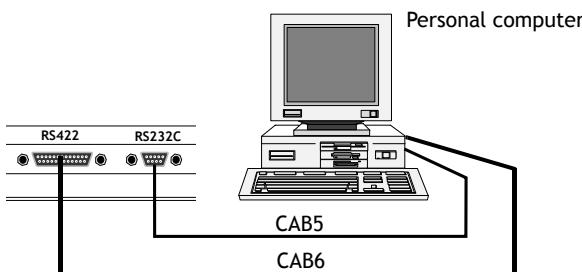
Pour programmer le terminal, il est recommandé d'utiliser le logiciel PC. Pour installer le logiciel PC référez-vous au manuel de ce produit. Il faut le paramétrage du logiciel PC et du terminal soient les mêmes.
