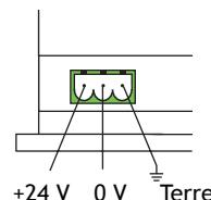
*La longueur maximale du câble d'alimentation électrique en 24 VCC est de 10 mètres.*
