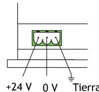
*La longitud máxima del cable de alimentación eléctrica de 24 V DC es de 10 metros.*
